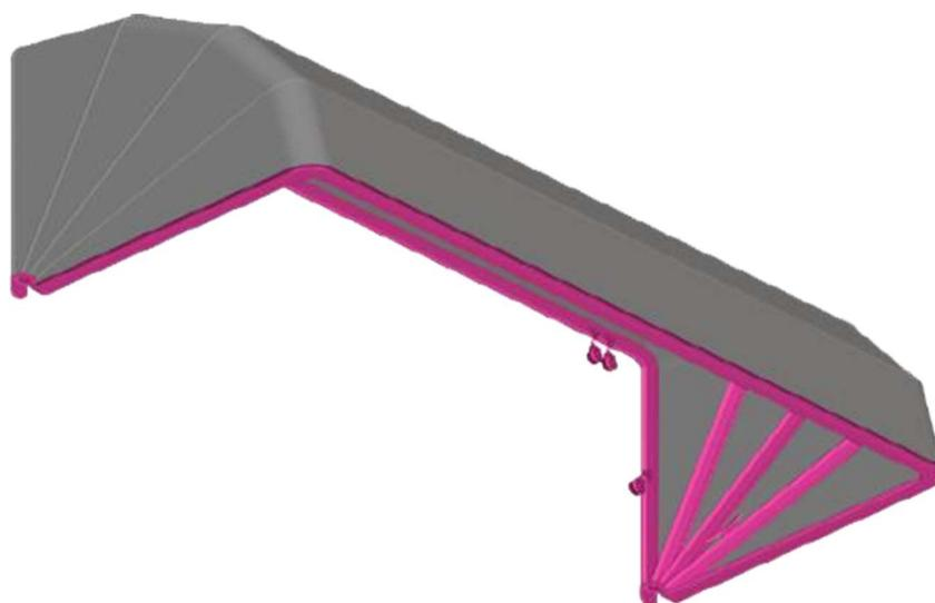
Le tende da sole a Cappottina **fino a 4 mt** sono realizzate con profilo in alluminio da 50 mm, da 4,01 mt a 7 mt con profilo da 70 mm su tutti gli elementi longitudinali; **da 5,01 mt a 7 mt** con un elemento longitudinale in K70 rinforzato e 70 mm sui rimanenti profili.
