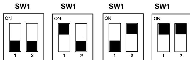
Passo Passo P/P + Discesa Test Sensore Sole Test Anemometro
