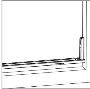
**5** Applicare la guida inferiore completa di attacchi a baionetta al pavimento, servendosi del biadesivo.
