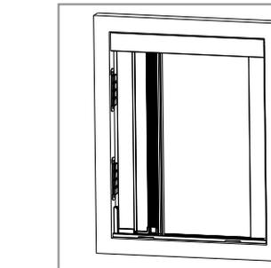
**10** Applicare il profilo laterale con la barra maniglia, facendo pressione sulle clips di fissaggio.
