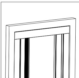
**11** Rimuovere il profilo magnetico dal profilo di riscontro e regolare la tensione del filo avvitando i due grani posti all'interno.
