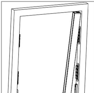
**8** Inserire il profilo di riscontro sotto la guida inferiore e farlo aderire alla parete laterale, scivolando delicatamente lungo la guida inferiore, facendo pressione sulle clips di aggancio.
