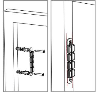
**7** Far aderire i profili laterali alle pareti al fine di tracciare la loro esatta collocazione sulla parete, applicando un segno con la matita. Applicare le clips di fissaggio (si raccomanda l'utilizzo delle clips di fissaggio quando l'altezza supera i 160 cm).
