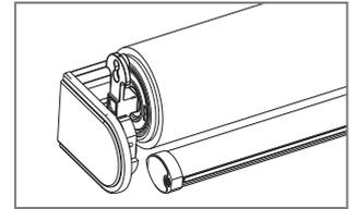
**d** Riposizionare il rullo nel supporto e fissare con la vite appositamente.
