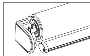
**d** Riposizionare il rullo nel supporto e fissare con la vite apposita.
