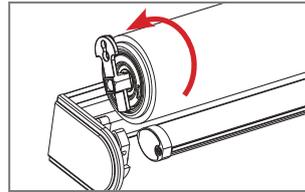
**c** Ruotare la levetta e regolare la molla.
