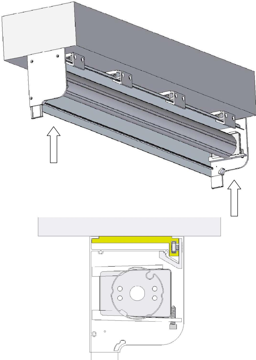
Avvitare i supporti alle piastre di fissaggio facendo attenzione nel centrare la piastrina filettata con la vite DIN 7991 M6x12.
