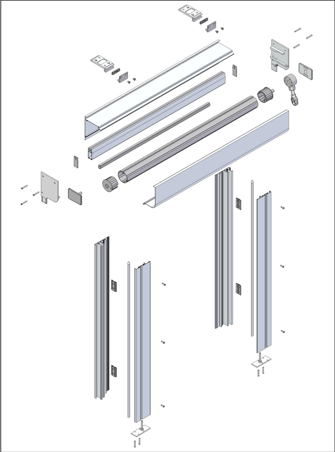
Posizionare le piastre di fissaggio sul soffitto o sul profilo regolabile a seconda dei casi.
