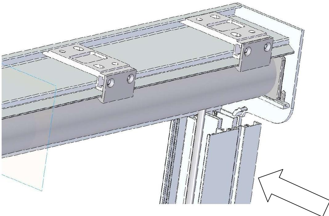
Per fissare la semiguia usare delle viti DIN7982 4,2x19 come mostrato in figura
