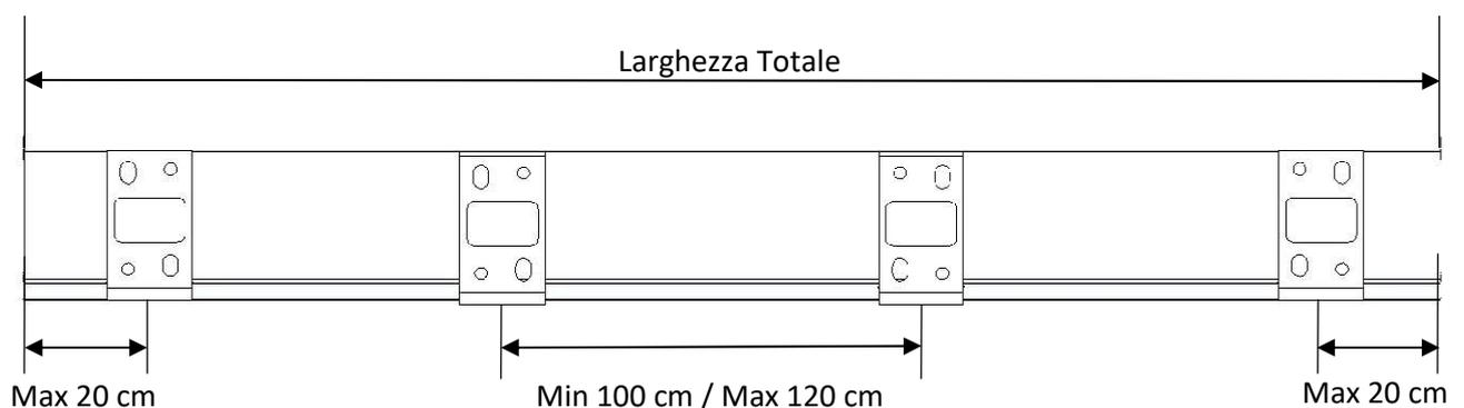
Fissare i tappi laterali sul profilo portante con le viti DIN 7982 4,2 x38 come mostrato in figura.
