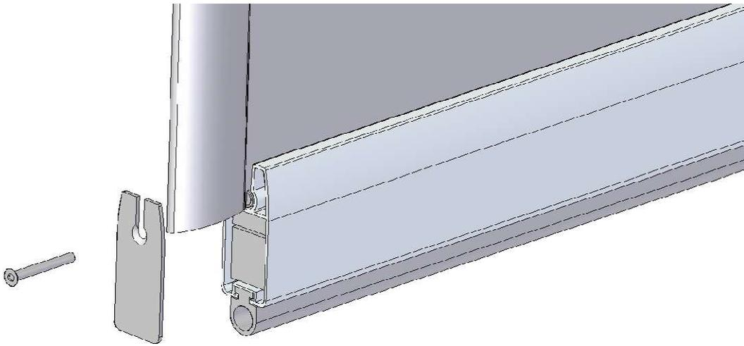
Prima di posizionare la semiguia 2, a tenda completamente avvolta, introdurre l'asta nell'apposita tasca del telo come mostrato in figura.
