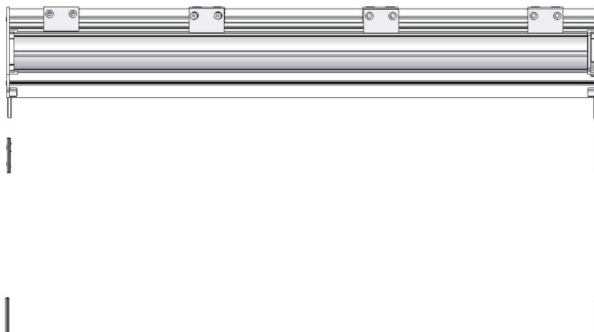
In seguito fissare il piede ( piastre ) alla semi guida 1 usando le viti DIN 7982 4.2x38. Avvitare fino in fondo, come mostrato in figura, l'asta nel perno filettato presente nel piede.
