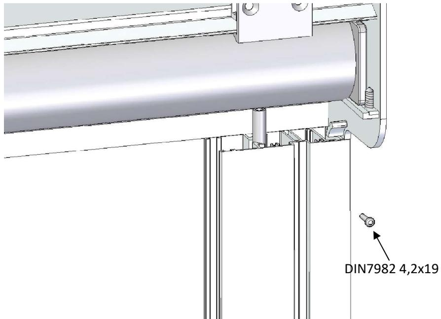
Infine posizionare i carter anteriore e fissarlo sugli estremi laterali con due viti
