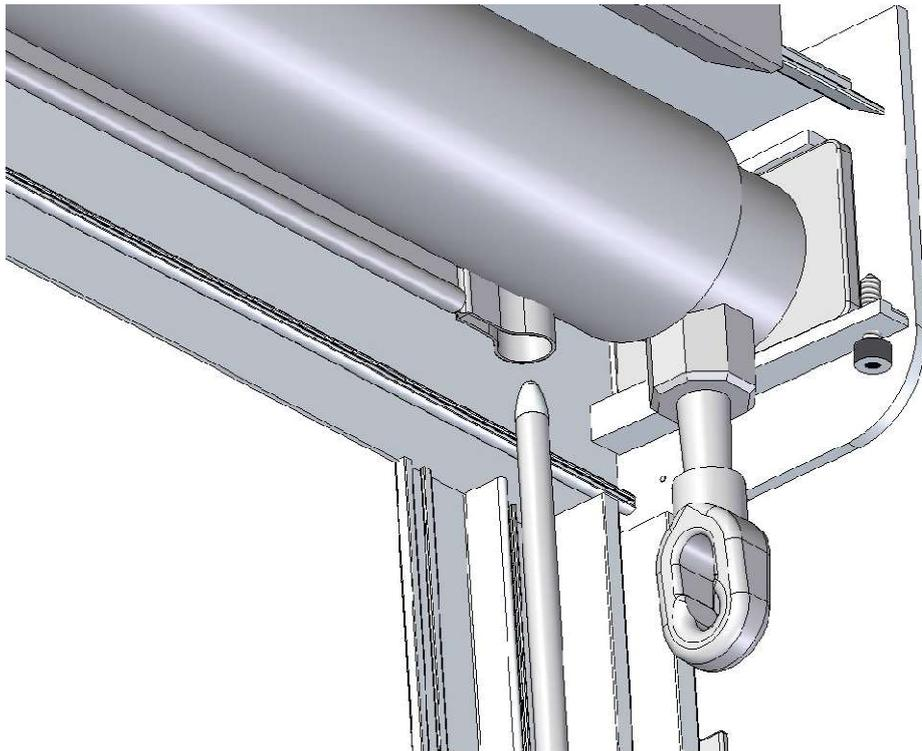
Inserire le piastre laterali negli appositi alloggiamenti della semi guida 1 come mostrato in figura
