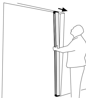
**4** Inserire gli agganci alle guide e forare in corrispondenza del foro per consentire il bloccaggio delle guide con le viti in dotazione
