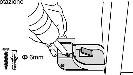
**3** Dopo la foratura inserire i tasselli e fissare con le apposite viti
